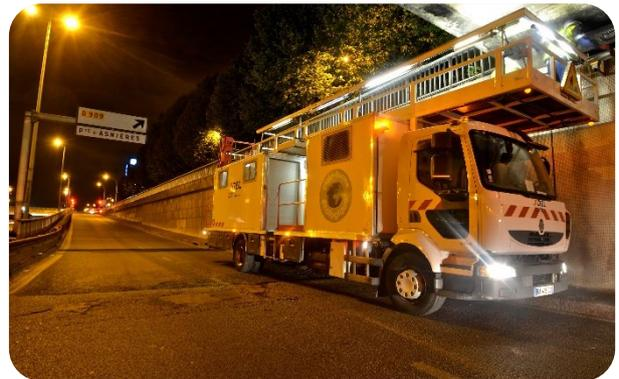
Pour les travaux récurant le long de piédroit de tunnel, nous avons un engin de chantier spécifique : sur un camion est montée une plateforme électrique motorisée qui permet de travailler à hauteur du matériel.
